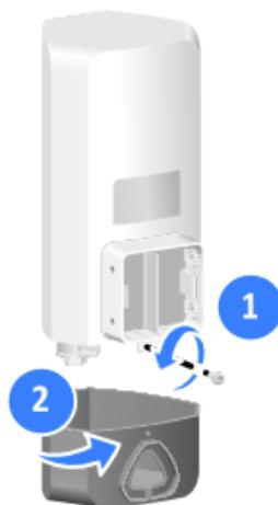
Figura 1-5 Remoção do parafuso de fixação
