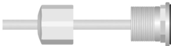
Gambar 2-3 Masukkan Kabel Ethernet
