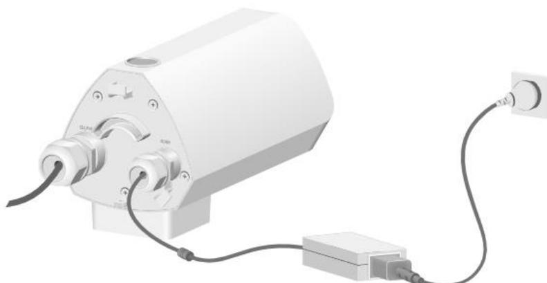
Figura 2-8 Conexión del Adaptador de Corriente Adecuado
