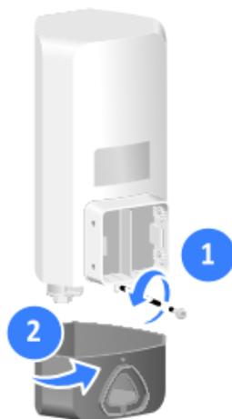
Figura 1-5 Retire el Tornillo de Fijación
